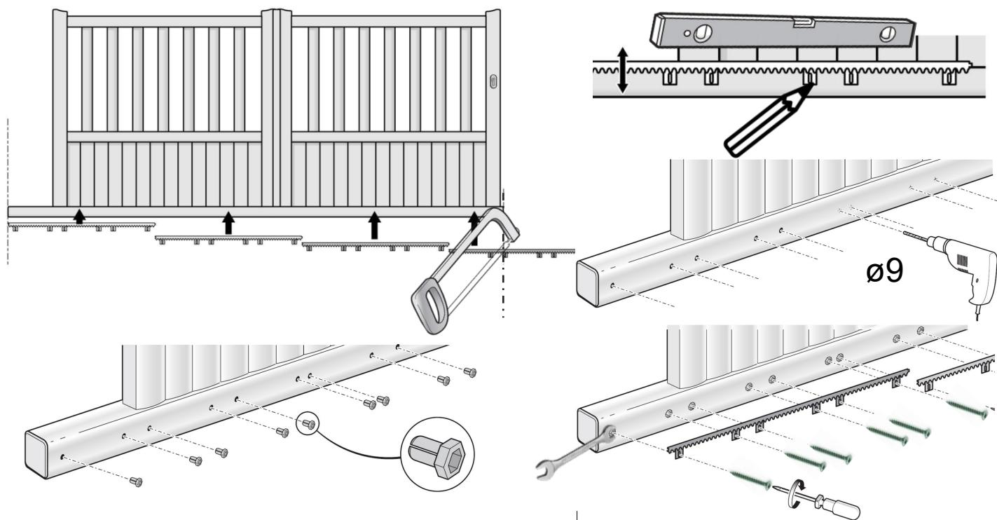
1 – Dans le cas d'une option motorisation demandée sans usinage serrure, bien alignée la cornière sur le montant
