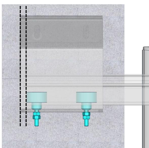
6 - Positionner le guidage en fonction du portail, de son jeu de pose et de son fonctionnement et vérifier l'aplomb du portail.
