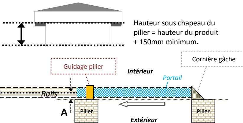
'A': distance entre le pilier et l'axe du rail= 55mm
