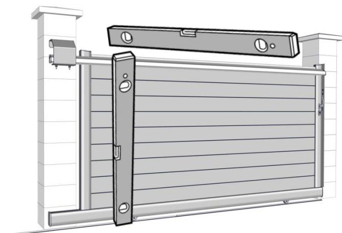
11 - Brider les différents éléments en gardant une distance entre la plaque et le montant du portail pour permettre le réglage de l'aplomb du portail.
